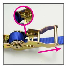
さらに軸の凹みに爪が掛かるまでハンドルを開き、ベルトを引き出します。
