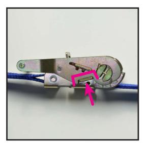
ベルトが十分に締まると、しっかりと荷物が固定できているか確認します。 締め終わると、ハンドルを最後まで閉じます。
