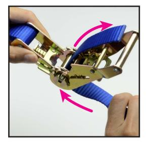
ラチェットハンドル軸部のスロットの下から、ベルト末端を通します。
