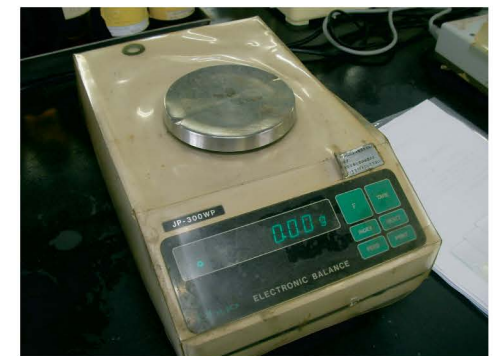
最大1/1000g計測できる 微細な重量計を用いる
