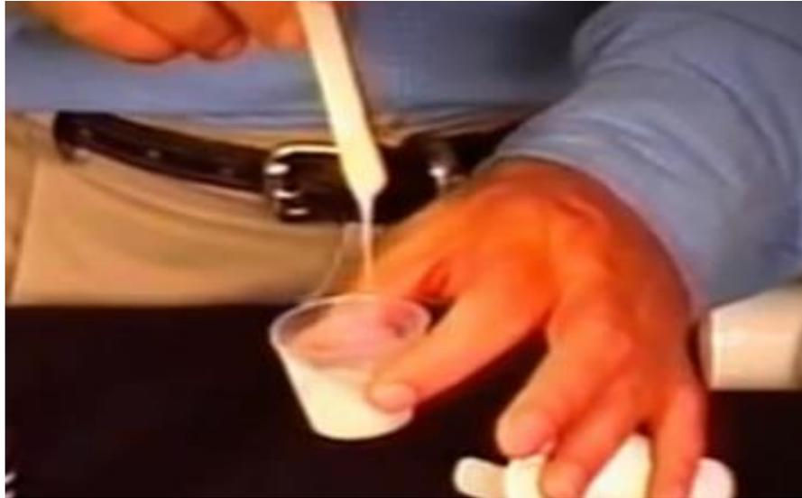
その後ペースト状→粘土質になります。混ぜ始めから約 15 分で、プラスチック状に硬化します。
